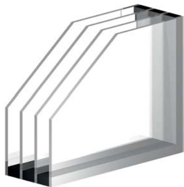
čtyřsklo 4-16-4-18-4-16-4 (matelux-čiré-čiré-matelux) - oboustranně překrytá výplň
