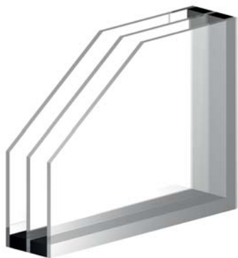
trojsklo 4-18-4-18-4 (matelux-čiré-matelux) - jednostranně překrytá výplň
