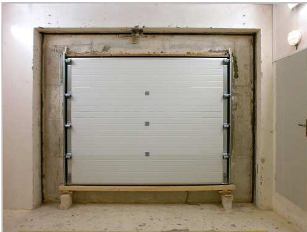
Sekční vrata zabudovaná ve zkušebním otvoru
